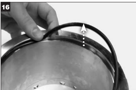
Удалите уплотнительное кольцо вала (V) из втулки и утилизируйте.
