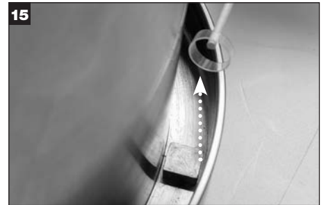
Удалите привод из поводков втулки и утилизируйте.
