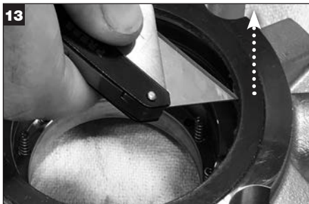
Удалите прокладку уплотнительной поверхности сальниковой коробки из сальника и утилизируйте.
