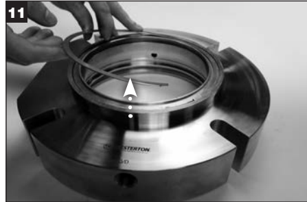
Для уплотнений с набором втулок. Удалите пружинное стопорное кольцо из сальника и утилизируйте.
