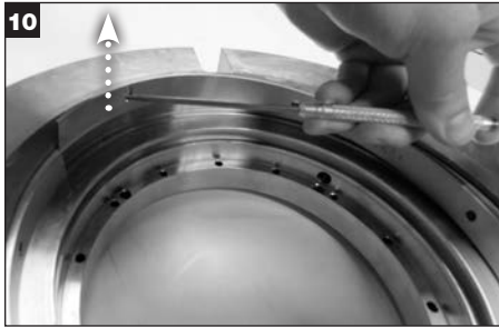
Для уплотнений с опцией инжектора. Осторожно удалите инжектор и отложите его в сторону.
